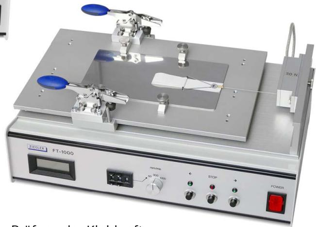
Prüfung der Klebkraft
